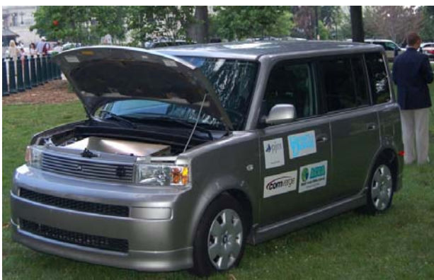
El vehículo desarrollado por el consorcio MAGICC, el cual funciona como punto de suministro y es reconocido como tal por el operador de la red.
